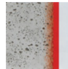
آغاز واکنشهای شیمیایی AQUAFIN-IC با رطوبت و آهک آزاد موجود در داخل بتن و تشکیل کریستالهای نامحلول
